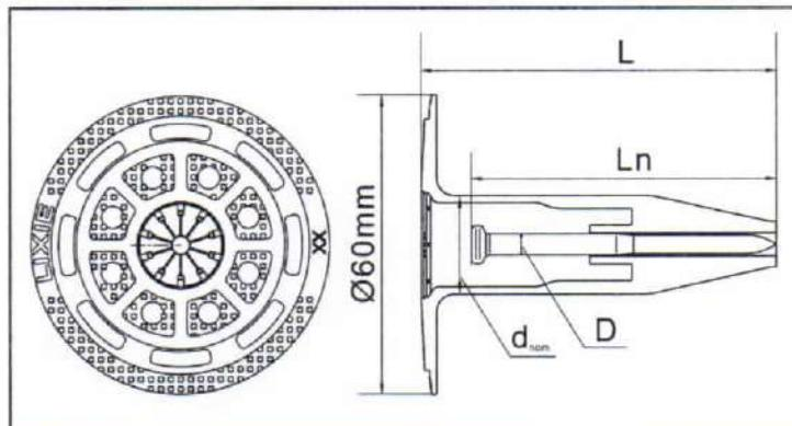
Рис.1. Дюбель WBD с гильзой диаметром шляпки 60 мм
